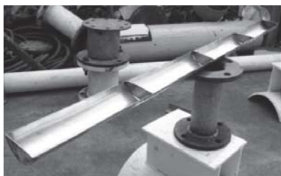
รูปที่ 8 รางใส่เกลือแคลเซียมคลอไรด์ที่อยู่ภายในเจนเนอเรเตอร์
