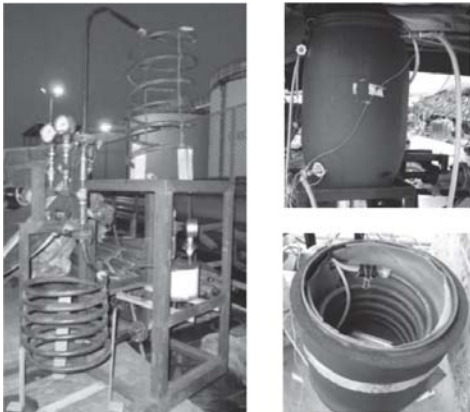
รูปที่ 5 โครงสร้างเครื่องควบแน่นและเครื่องทำระเหย
