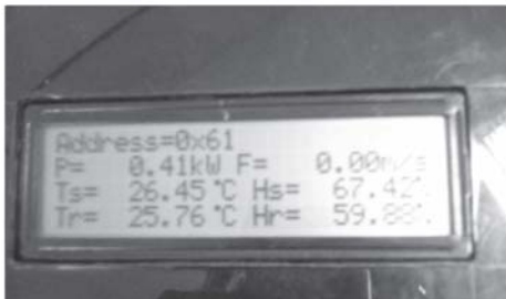
รูปที่ 4. หน้าจอแสดงผลการชดวัดกำลังไฟฟ้าทำการป้อนโหลด 400 วัตต์ บนหน้าจอนึกเหลว
