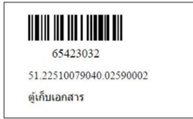
รูปที่ 2 บาร์โค้ดรหัสสินทรัพย์ (บาร์โค้ดแบบ 128)
