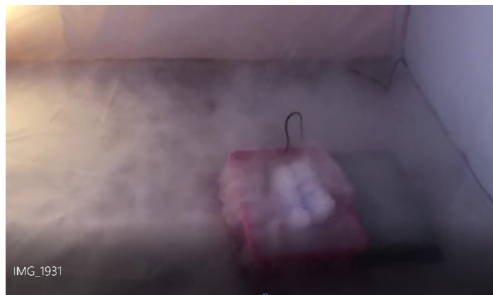
รูปที่ 5 การทดสอบการไหลของอากาศด้วยเครื่องสร้างหมอกอัลตราโซนิค
