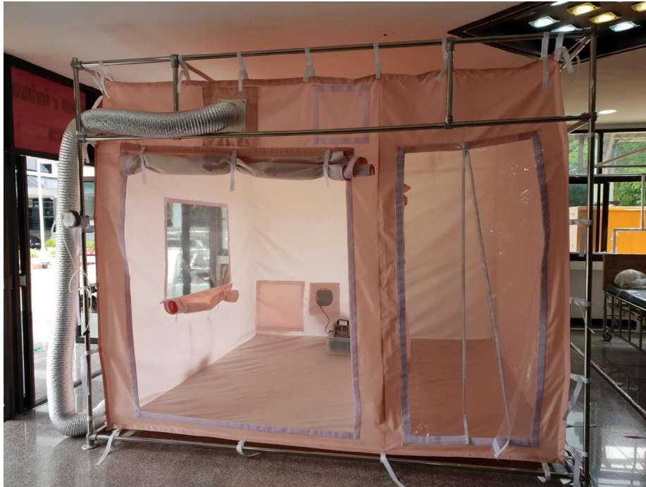
รูปที่ 3 ห้องแยกส่วนความดันลบแบบเคลื่อนที่ได้สำหรับโรงพยาบาลสนาม
